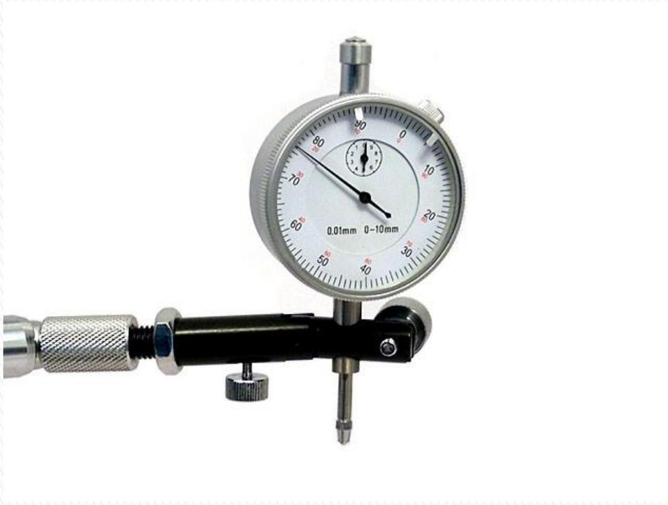
Инструмент используем для контроля торцевого биения 0,06 мм, относительно базовой поверхности.
