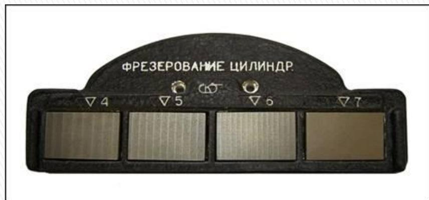
Для контроля чистоты поверхности Rz 25, Rz 50, Rz 12,5, Ra 1,6 способом сравнения применялись образцы шероховатости для точения и фрезерования
