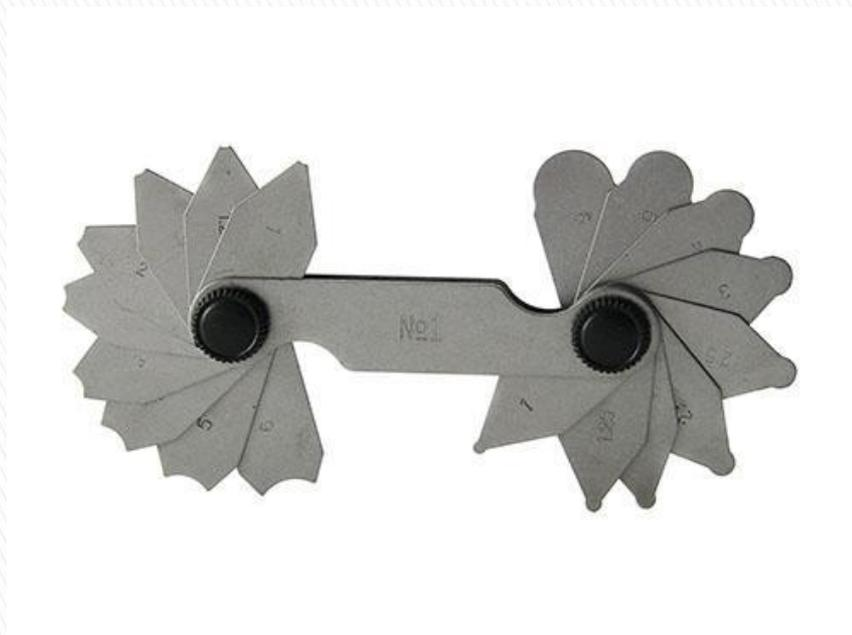
Инструмент используем для контроля режущего инструмента, используемого для выполнения радиусов R1 и R 0,5 (размер обеспечивается инструментом).
