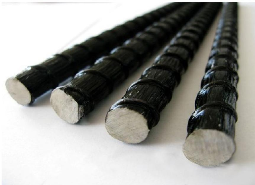
*Профили из базальтопластиковой арматуры в перспективе могут заменить все конструкции, как стальные, так и из прочих строительных материалов (алюминий, дерево, пластмассы) работающие в агрессивных и морских средах.*
