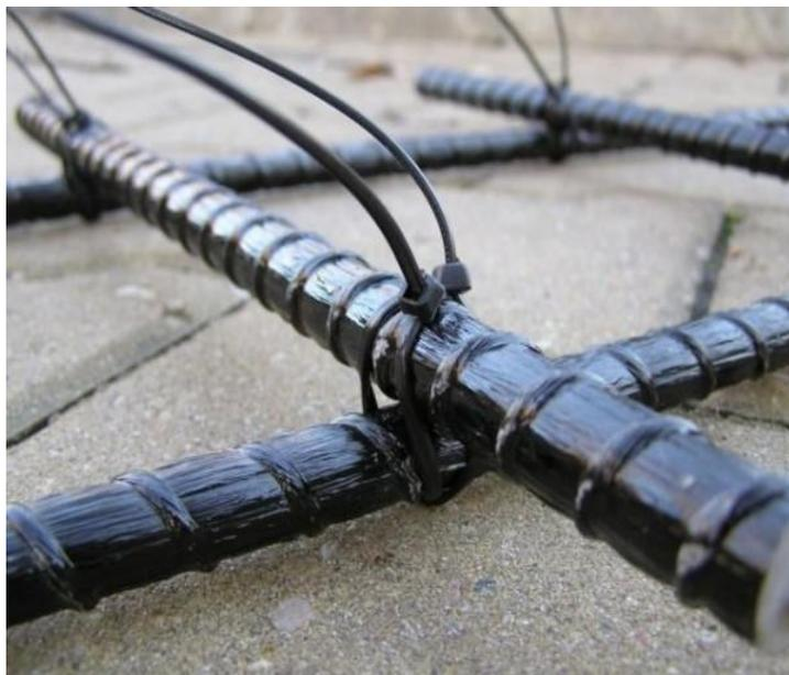
Базальтопластиковая арматура применяется в качестве армирующего материала в строительных несущих и ограждающих конструкциях.
