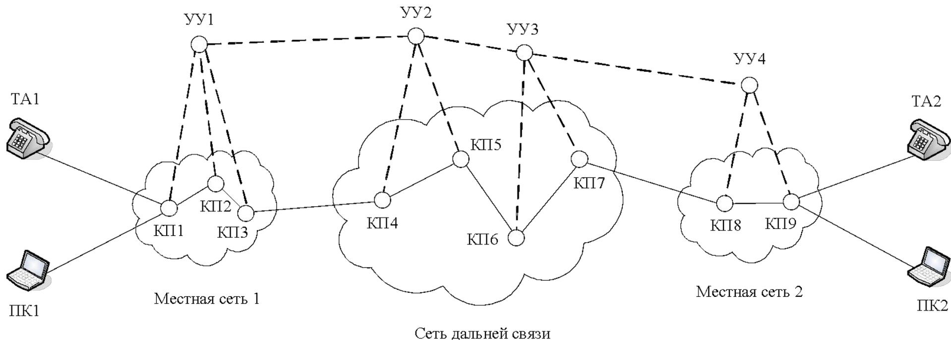
Передача информации, в которой заинтересованы пользователи, осуществляется коммутаторами пакетов (КП, Packet Switch – PS). Вторая функция возложена на устройства управления (УУ, Control Unit – CU), в качестве которых могут использоваться различные аппаратно-программные средства (например, Softswitch).
