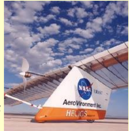
Двигатель и подвес с оборудованием и шасси
