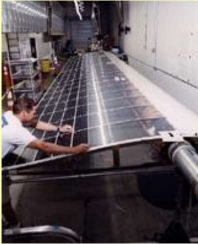
Сборка фотоэлементов крыла Helios
