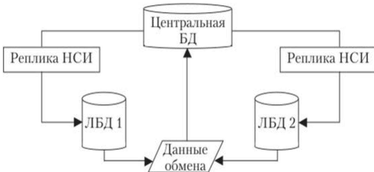
Схема реплицирования локальных БД
