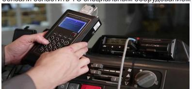
Тахограф - это специализированный прибор для измерения, позволяющий осуществлять контроль транспортного средства во время движения. А именно: сохранение информации о фактах нарушения установленного скоростного режима; отслеживание расстояния и маршрута пройденного пути; контроль над соблюдением водителем требований трудового законодательства, регламентирующего время труда и отдыха.
