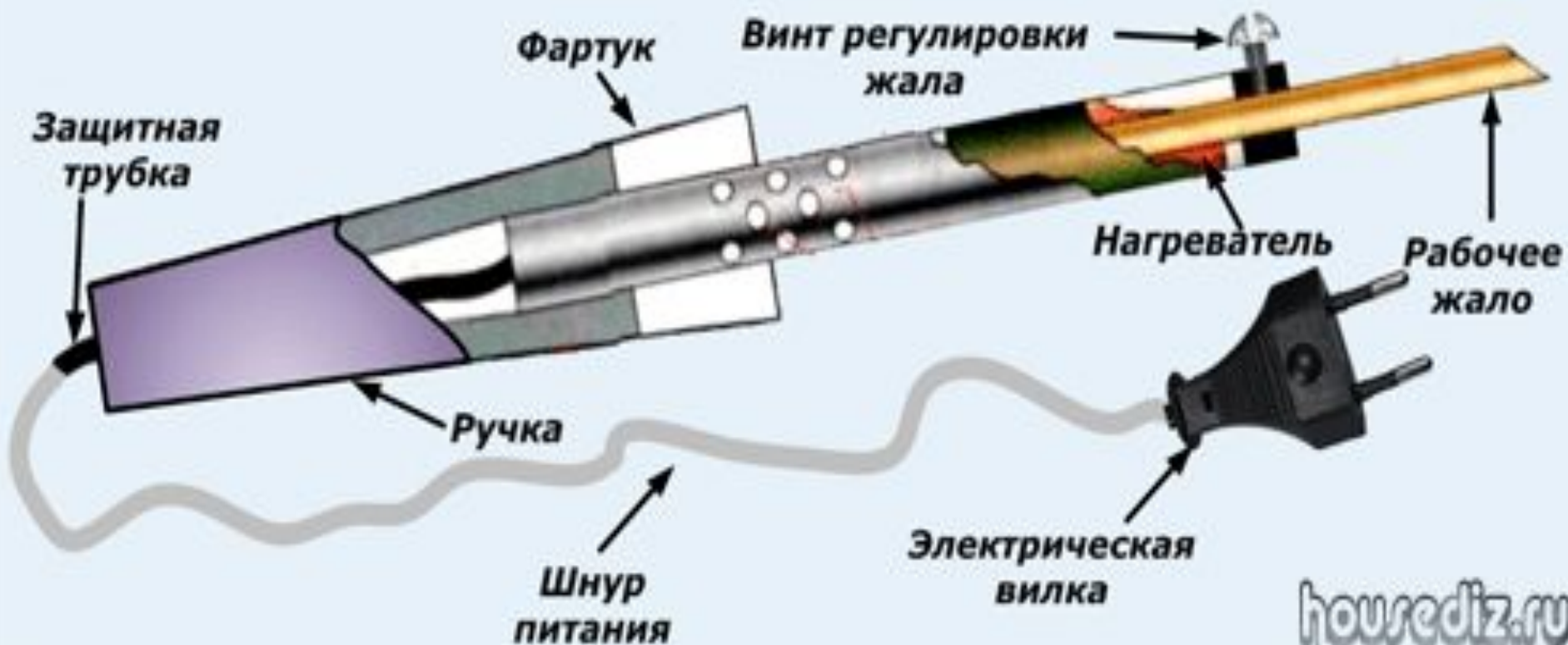
Устройство электрического паяльника с резистивным нагревом
