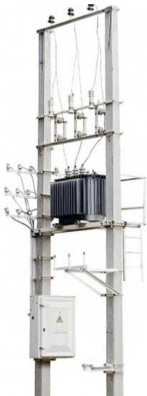
Мощность столбового КТП составляет от 16 до 250 кВА. Монтаж электроустановки этого типа имеет свои особенности. Провода, которые соединяют линии электроэнергии и силовой трансформатор, прокладываются в трубах. Каждая труба должна надежно крепиться к опоре. Подключение подстанции к линиям электропередач осуществляется с помощью разъединителя
