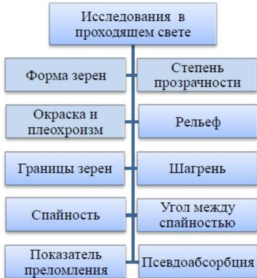
Рис. 8. Схема изучения минералов при одном николе
