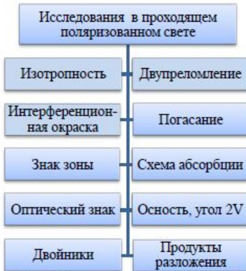
Рис. 18. Схема изучения минералов при двух николях
