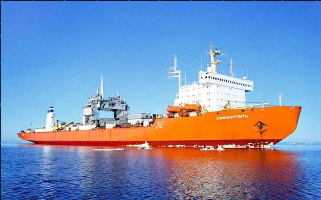
**Лихтеровозы (Lighter Ships)** — это суда, где в качестве грузовых единиц используются несамоходные баржи — лихтеры, погрузка которых на судно в порту производится с воды, а выгрузка соответственно на воду.
