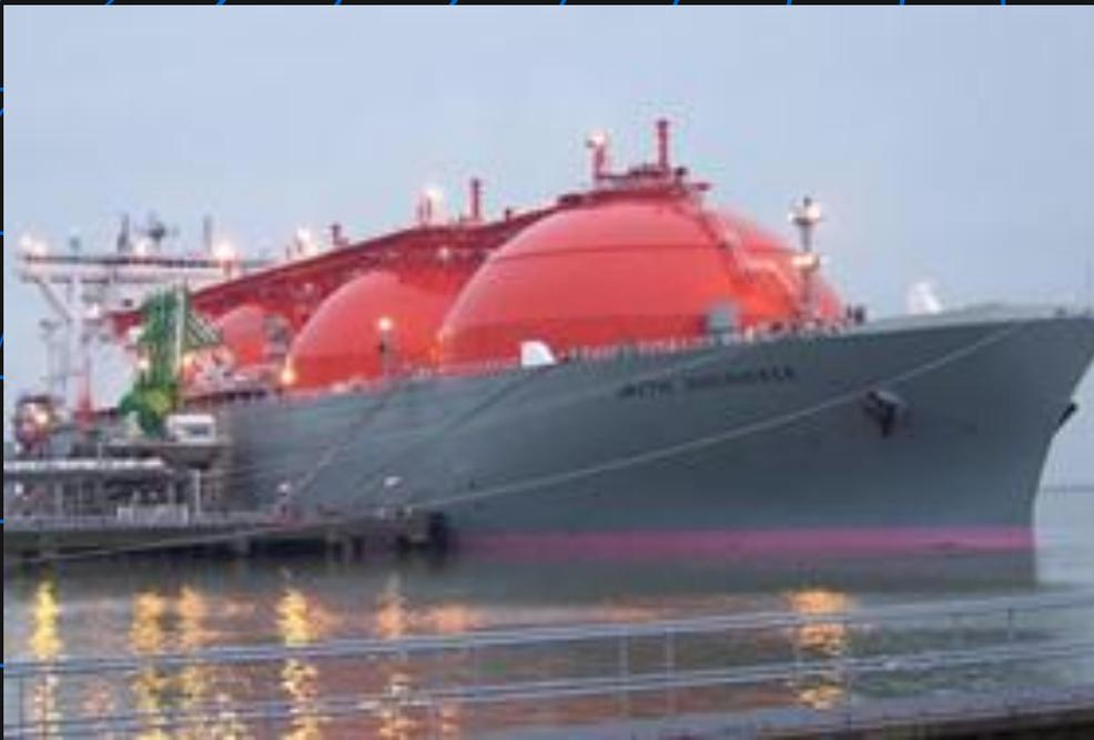
**Газовозы** осуществляют перевозки различных газов (пропан, метан, аммиак), которые перевозятся в сжиженном состоянии. Морские газовозы имеют вкладные цистерны цилиндрической, прямоугольной и сферической формы. Например, газовозы, для доставки метана, который перевозится при температуре до  $-160$  оС, имеют цистерны прямоугольной формы. Морские газовозы оборудованы насосами, системой трубопроводов, компрессорами - для выполнения разгрузочных операций.
