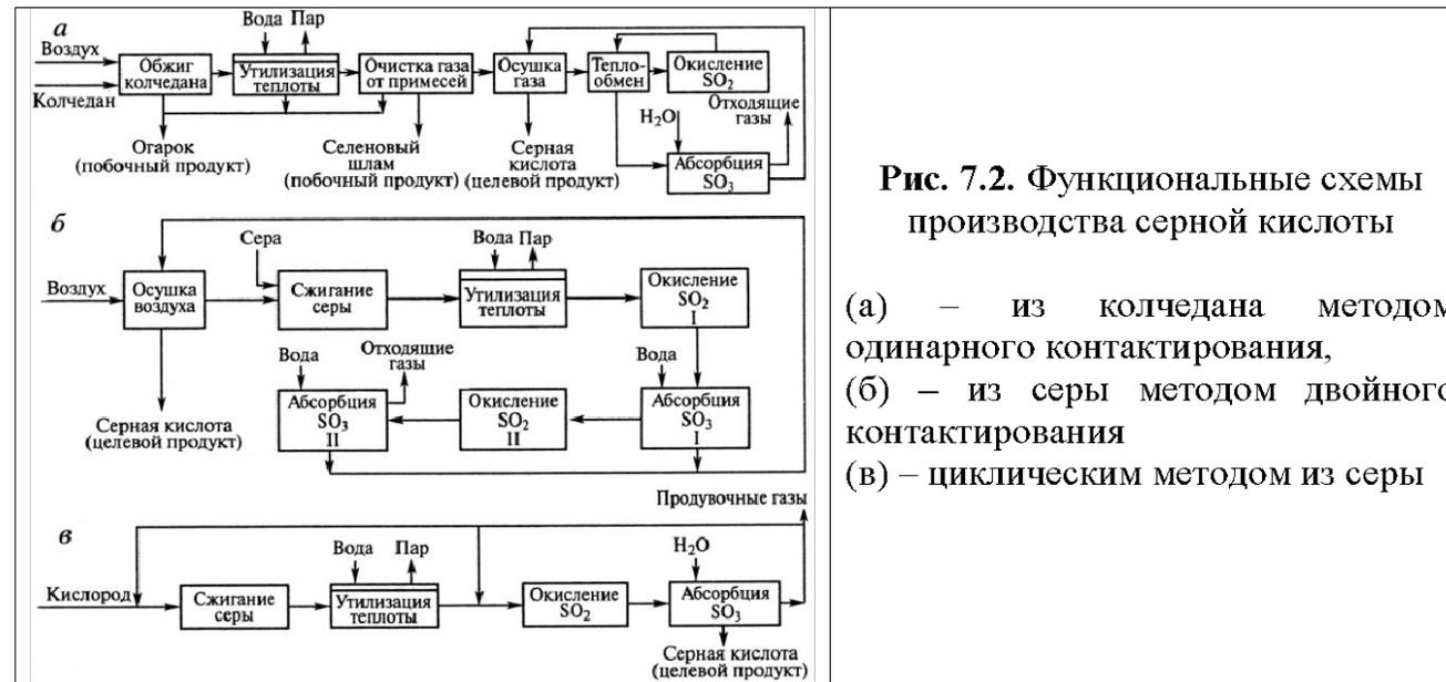
Рис. 7.2. Функциональные схемы производства серной кислоты
