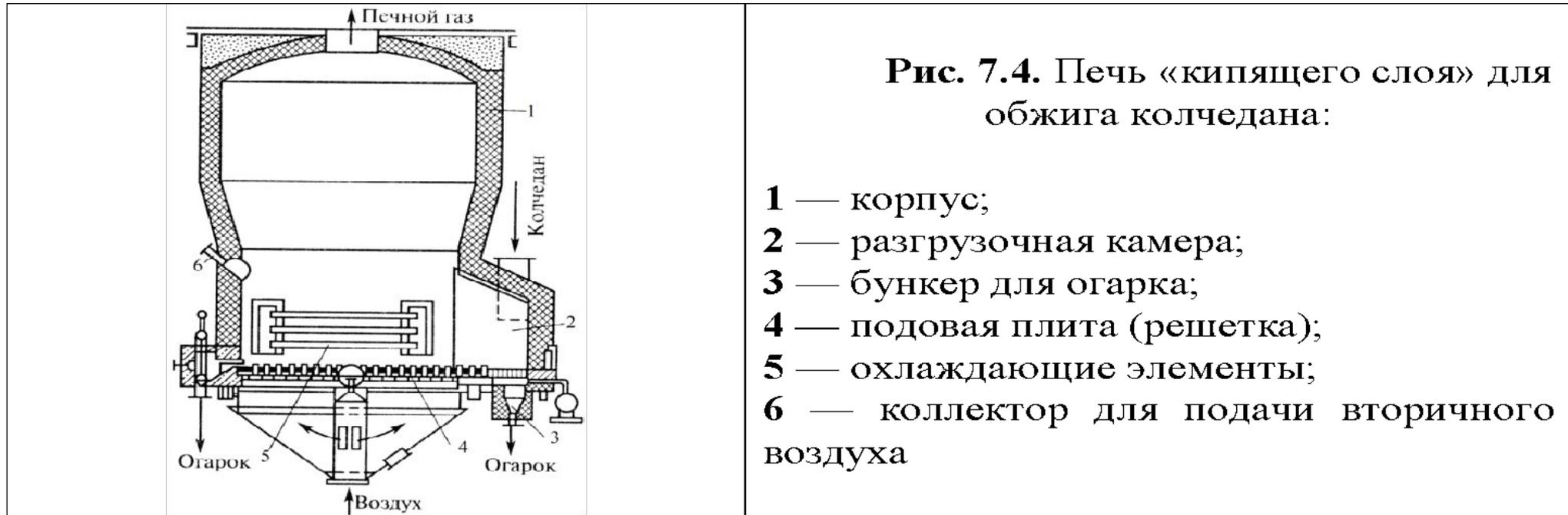
Печное отделение включает в себя помимо печи обжига колчедана котел-утилизатор и аппараты для очистки обжигового газа от огарковой пыли.
