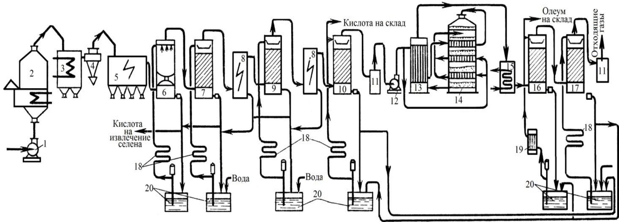
1,12-нагнетатели; 2-печь КС; 3-котёл-утилизатор; 4-циклон; 5-сухой электрофильтр; 6 - первая промывная башня; 7-вторая промывная башня; 8-мокрые электрофильтры; 9-увлажнительная башня; 10-сушильная башня; 11 – брызгоуловители; 13- теплообменник; 14-контактный аппарат; 15-ангидридный холодильник (экономайзер); 16-олеумный абсорбер; 17 - моногидратный абсорбер; 18- оросительные холодильники; 19-трубчатые холодильники; 20-сборники кислоты.
