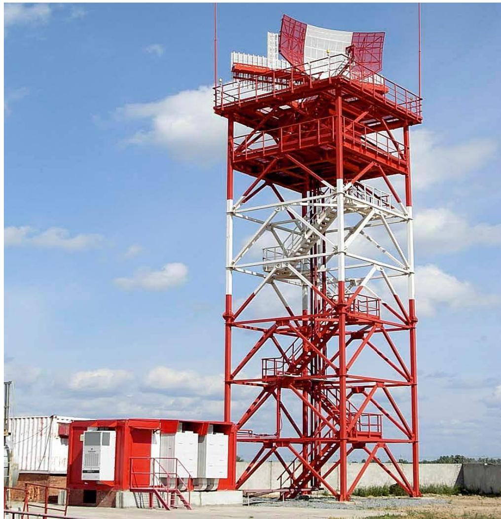
Аэродромный РЛК S-диапазона «Лира-А10» предназначен для использования в качестве источника радиолокационной информации о воздушной обстановке в зоне аэропортов для автоматизированных и неавтоматизированных систем УВД
