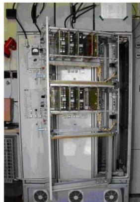
*Рис.10. Шкаф синхронизации и сопряжения в выдвинутом положении*
