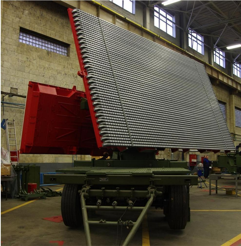
Антенное устройство первичного радиолокатора - фазированная антенная решетка (ФАР) с частотным управлением положения луча в вертикальной плоскости; антенны МВРЛ и НРЗ - моноимпульсные антенные решетки, расположенные с тыльной стороны антенны ПОРЛ («спина-к-спине»). Вращение по азимуту обеспечивается безредукторным приводом вращения.
