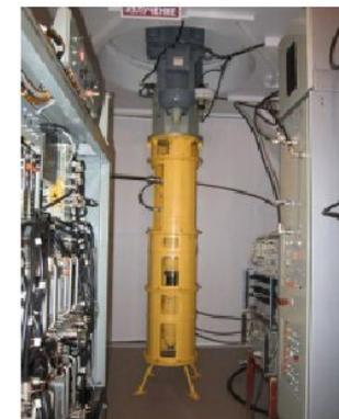
*Рис.12. Мотор-редуктор и колонна переходов вращающихся*
