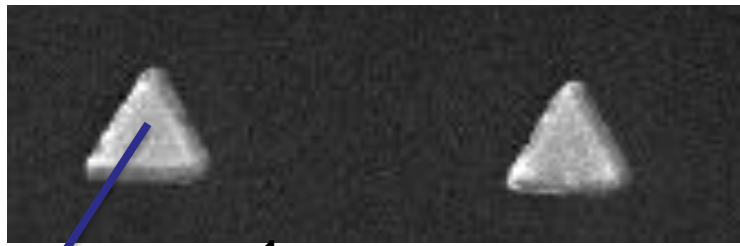
Нанотреугольники из NiFe позволяют хранить и переключать состояния намагниченности
