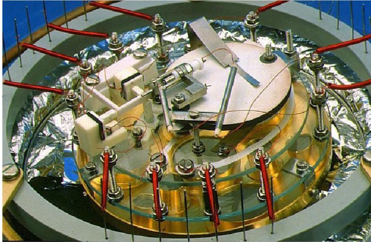
Рис.12. Фотография функционального блока первого СТМ (фотография любезно предоставлена Г. Биннигом для размещения на странице музея СЗМ Российского общества СЗМ и нанотехнологии)
