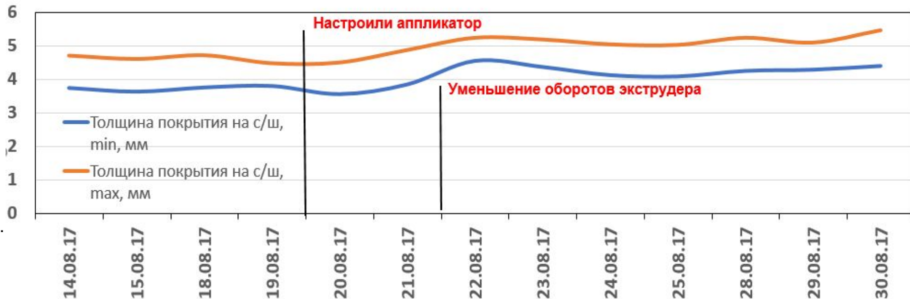
График изменения толщины покрытия над сварным швом
