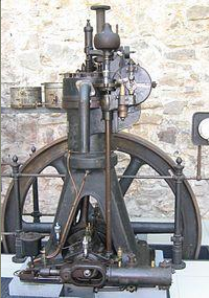
Стационарный одноцилиндровый дизельный двигатель, Германия, Аугсбург, 1906 г.
