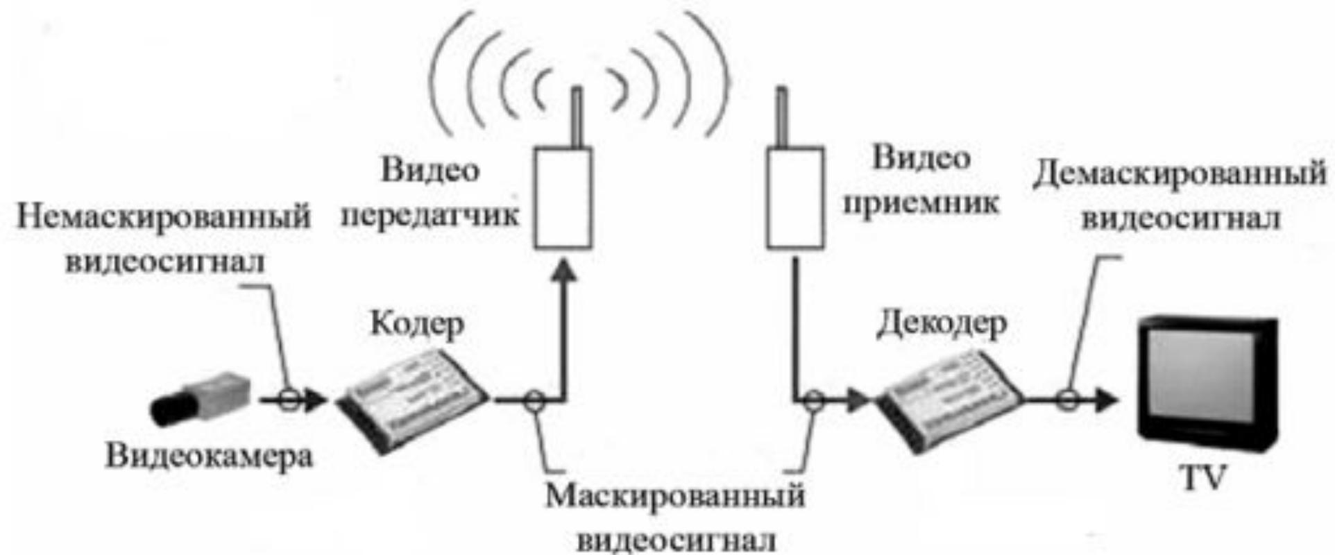
Для передачи видеоинформации она, как правило, кодируется кодером, передается по проводным или беспроводным каналам связи, а затем декодируется декодером и показывается на экране телевизора, монитора и пр.
