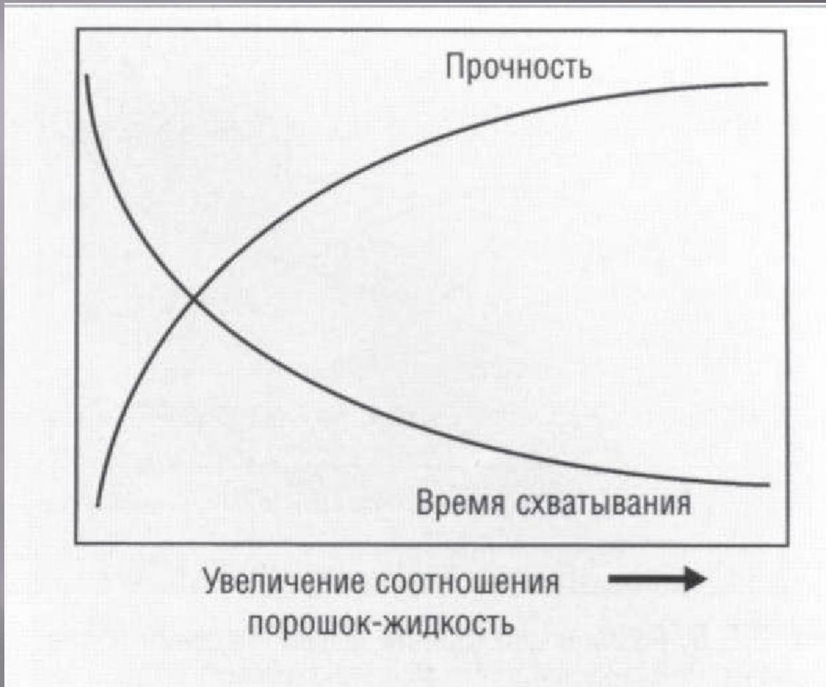
Рис. 2.3.4. Влияние изменений соотношения порошок-жидкость на свойства стеклоиономерных цементов
