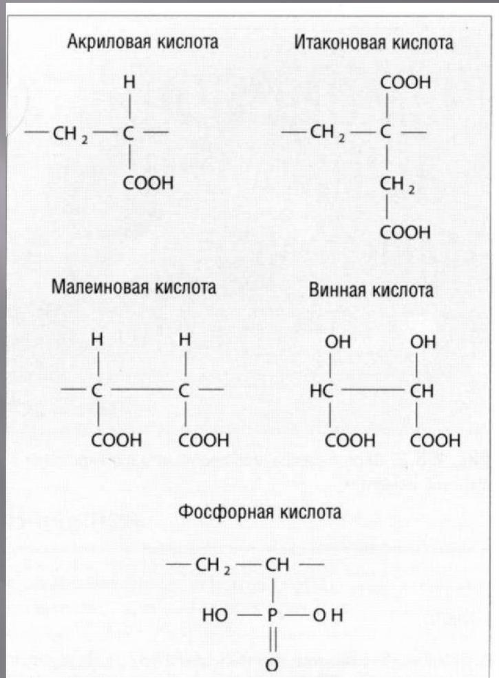
Рис. 2.3.3. Кислоты , используемые в составах стеклоиономерных цементов
