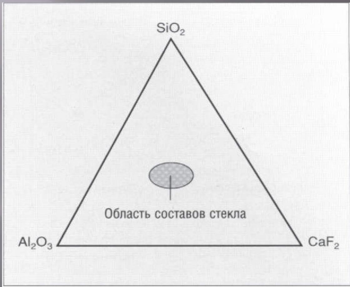
Рис. 2.3.2. Состав стекла, используемого в стеклоиономерных цементах
