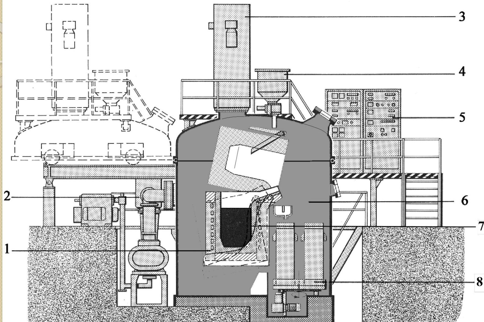
1 – индуктор, 2 – вакуумная система, 3 – камера загрузки, 4 – дозатор для введения присадок, 5 – пульт управления, 6 – плавильная камера,
