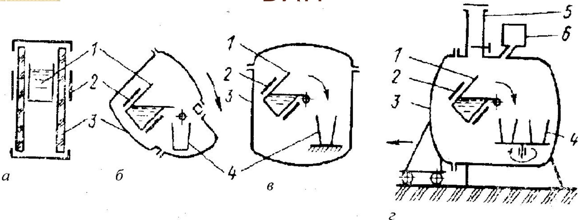
Схемы ВИП: а - индуктор расположен вне вакуумной камеры; б-г - индуктор расположен внутри вакуумной камеры; б - разливка путем наклона вакуумной камеры; в, г - разливка путем наклона тигля; г - ВИП полунепрерывного действия; 1 - тигель; 2 - индуктор; 3 - кожух; 4 - изложница; 5 - камера загрузки; 6 - дозатор
