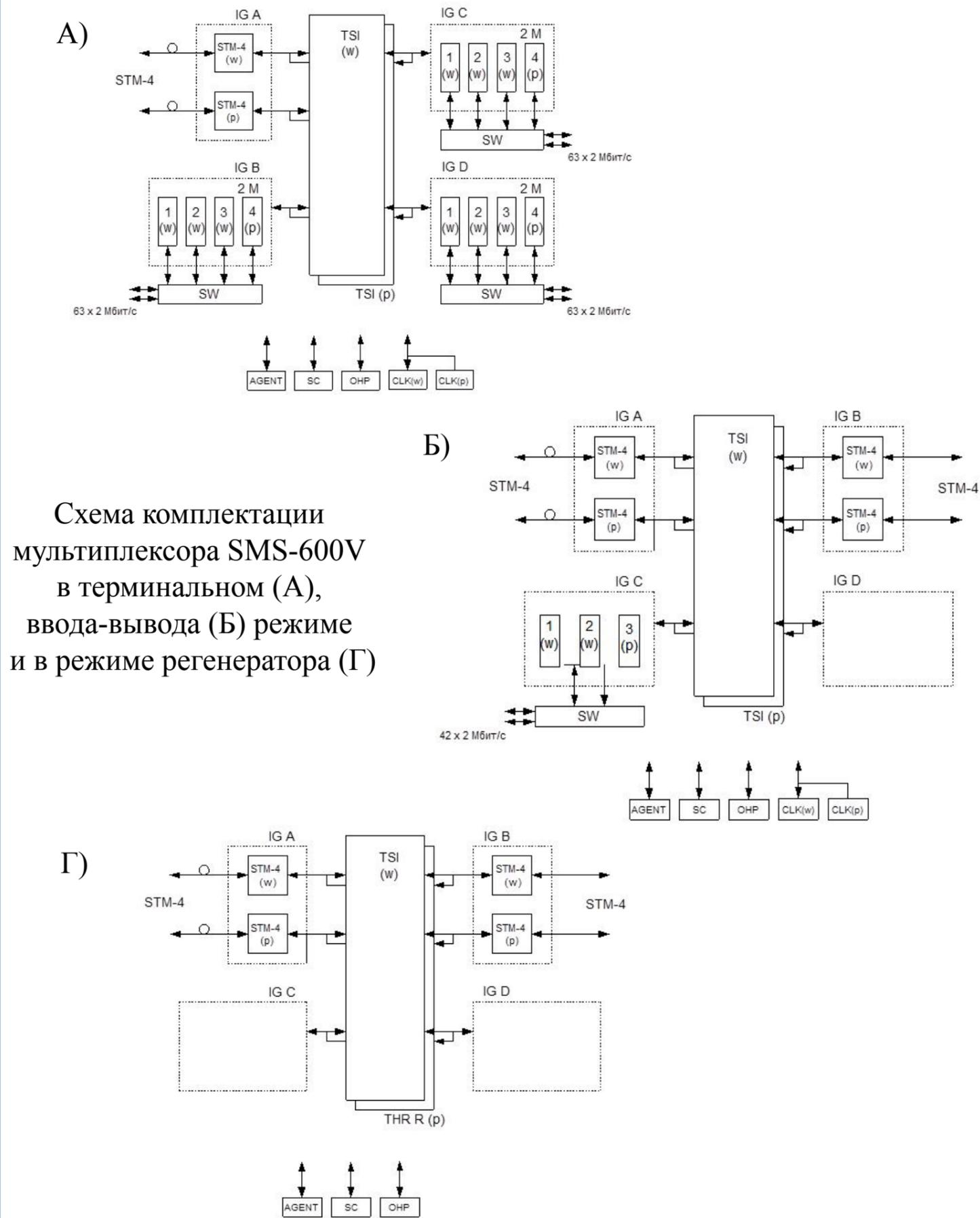
Схема комплектации мультимплексора SMS-600V в терминальном (А), ввода-вывода (Б) режиме и в режиме регенератора (Г)
