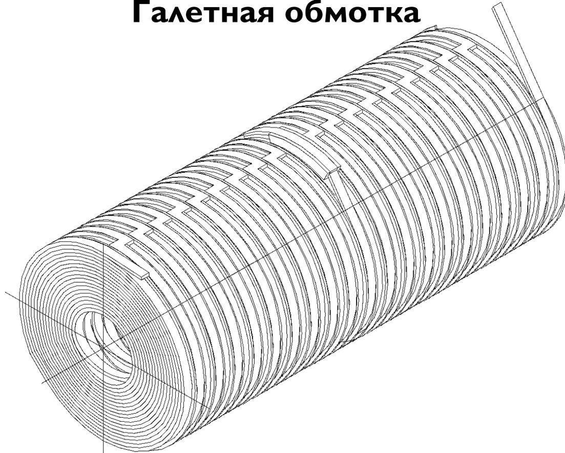
Обмотка состоит из последовательно соединенных двадцатигалетных блоков. Предполагали впервые использовать разработанный способ изготовления многогалетных обмоток. Ранее был известен способ изготовления лишь двойных галет.
