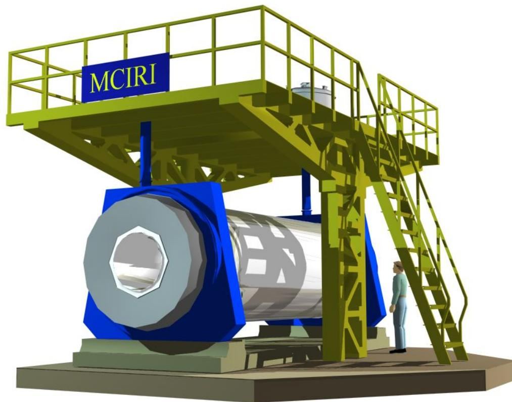
Сверхпроводящий магнит сепаратора изотопов гадолиния
