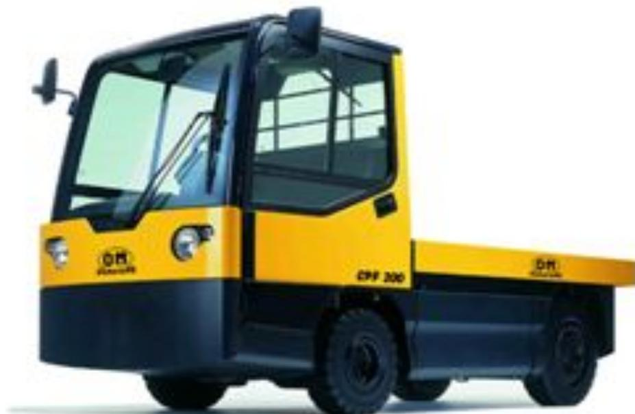
Электрокары могут быть с подъёмной и неподъёмной платформой, управляются сидящим или стоящим на машине водителем. Грузоподъёмность от 0,5 до 100 т и более
