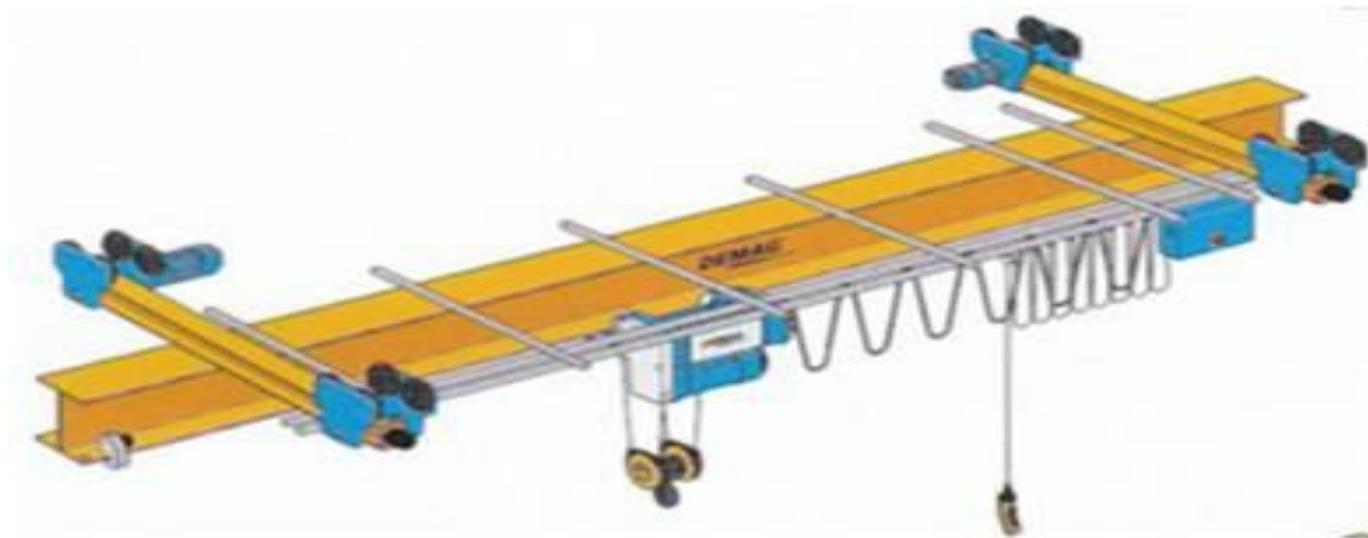
В складских хозяйствах широко применяются кран-балки. Кран-балки - разновидность подъёмного крана мостового типа, у которого тельфер передвигается по ездовой балке
