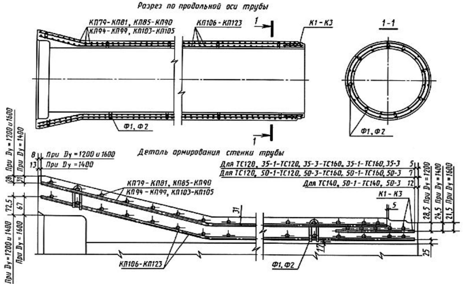
Ж/б труба диаметром 1200мм -1600 мм с двумя сетками армирования
