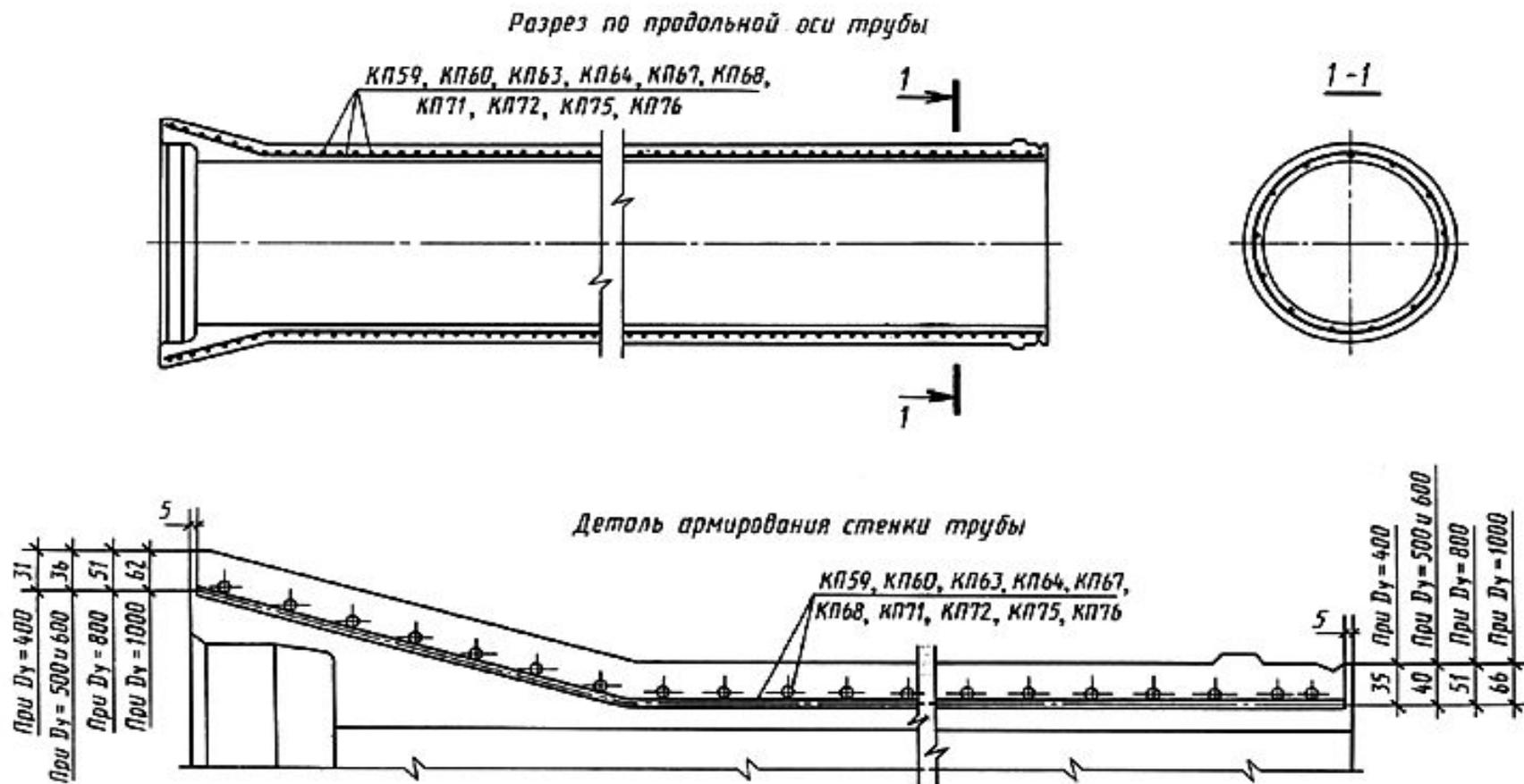
Ж/б труба диаметром 1000 мм с одной сеткой армирования
