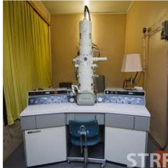
Метод просвечивающей электронной микроскопии позволяет изучать внутреннюю структуру исследуемых материалов:
