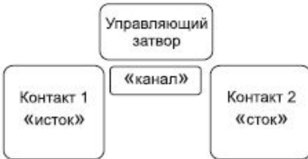
Принципиальная схема транзисторной структуры с управляющим затвором
