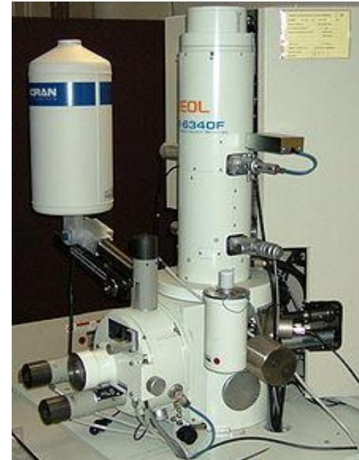
Тонкий электронный зонд (электронный пучок средних энергий (200 эВ – 50 кэВ) направляется на анализируемый образец.
