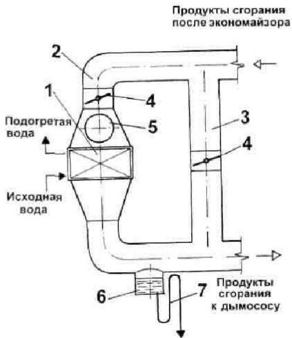
Рис. 4.1. Схема теплоутилизационной установки:
