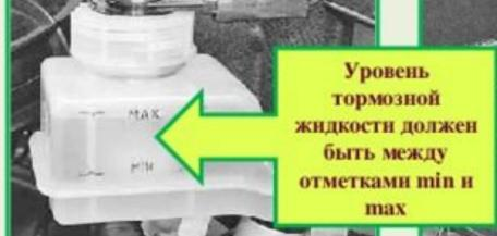
Если уровень жидкости ниже метки «MIN», выверните пробку бачка с вмонтированным датчиком сигнальной лампы аварийного состояния тормозной жидкости
