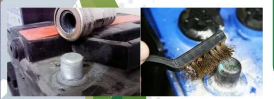
Аккуратно откручиваем стягивающий болт, очищаем клеммы, ставим на место, смазываем
