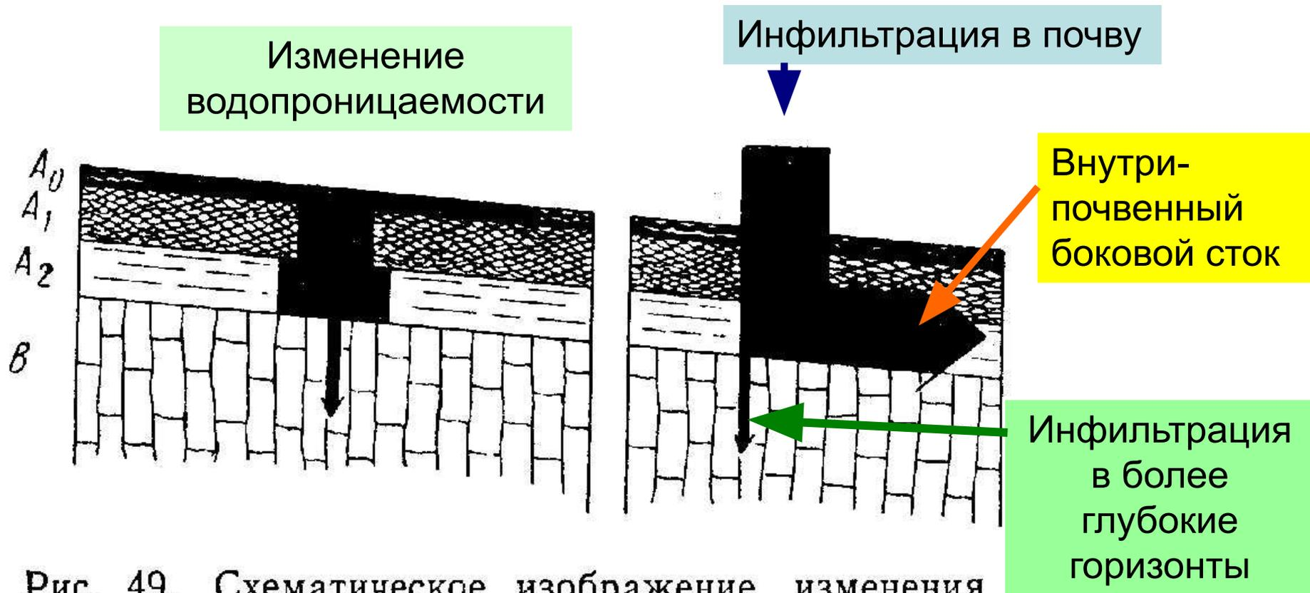
Рис. 49. Схематическое изображение изменения с глубиной водопроницаемости подзолистой почвы (слева) и возникновения почвенного стока (справа)
