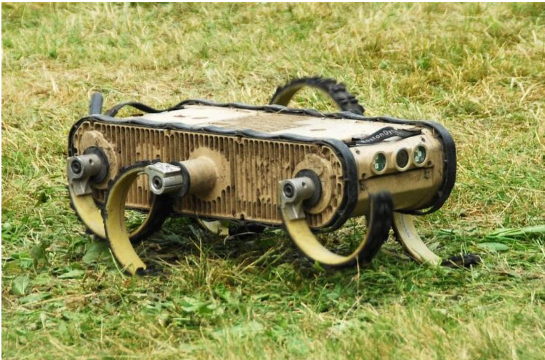
Широко известен робот RHex, созданный известной робототехнической компанией Boston Dynamics. Это шестиногий, способный передвигаться по разным типам местности на скорости, превышающей 5 длин тела в секунду (2,7 м/с), забираться по склонам крутизной 45 градусов, плавать и подниматься по ступенькам.
