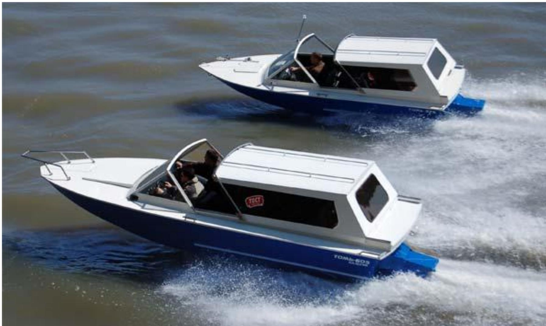
Водомёт - судовой движитель, у которого сила, движущая судно, создается выталкиваемой из него струей воды. Инженеры создали движитель, подобный движителю кальмара: это водомёт, действующий при помощи обычного бензинового или дизельного двигателя. Они особенно удобны на реках с перекатами и мелями.
