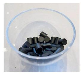
Не случайно ядерное топливо чаще всего выпускается в виде керамических таблеток, которые укладывают в герметичную упаковку — тепловыделяющие элементы, удобные для транспортировки и погружения в активную зону реактора.
