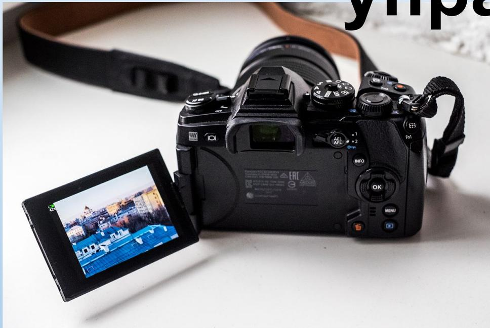
Дисплей сенсорный, с его помощью можно управлять почти всеми параметрами и функциями, как во время съемки, так и при просмотре. Прикосновением к экрану можно указывать камере область фокусировки, или одновременно выполнять спуск затвора.
