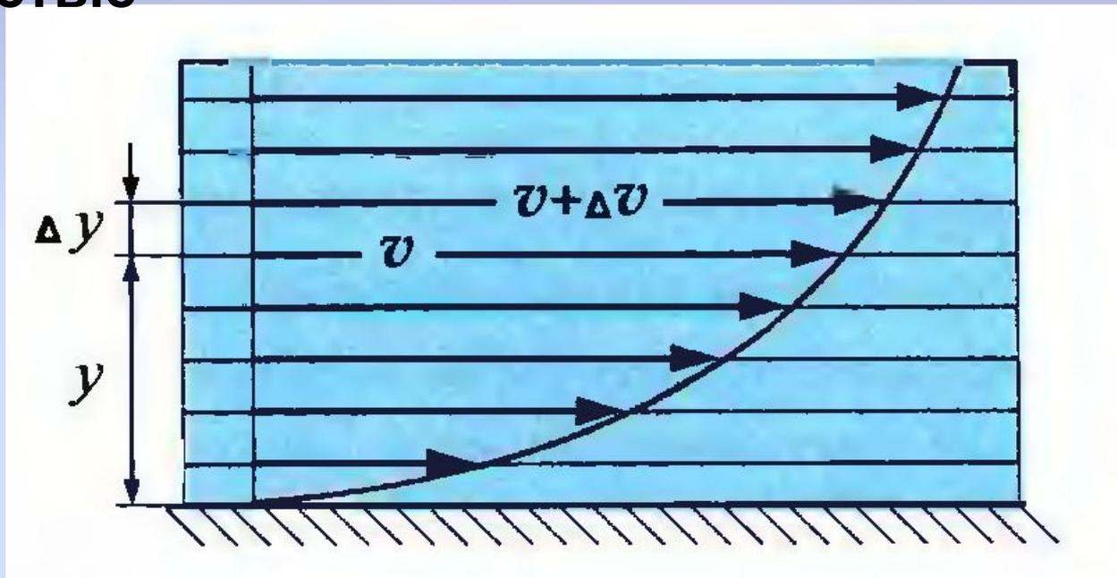
Профиль скоростей при течении вязкой жидкости
