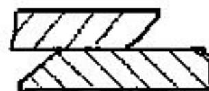
Угловое соединение со скосом одной кромки
