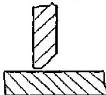
Нахлесточное соединение со скосом двух кромок
