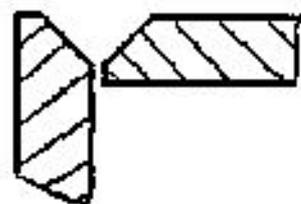
Торцевое соединение со скосом кромок на трубной доске
