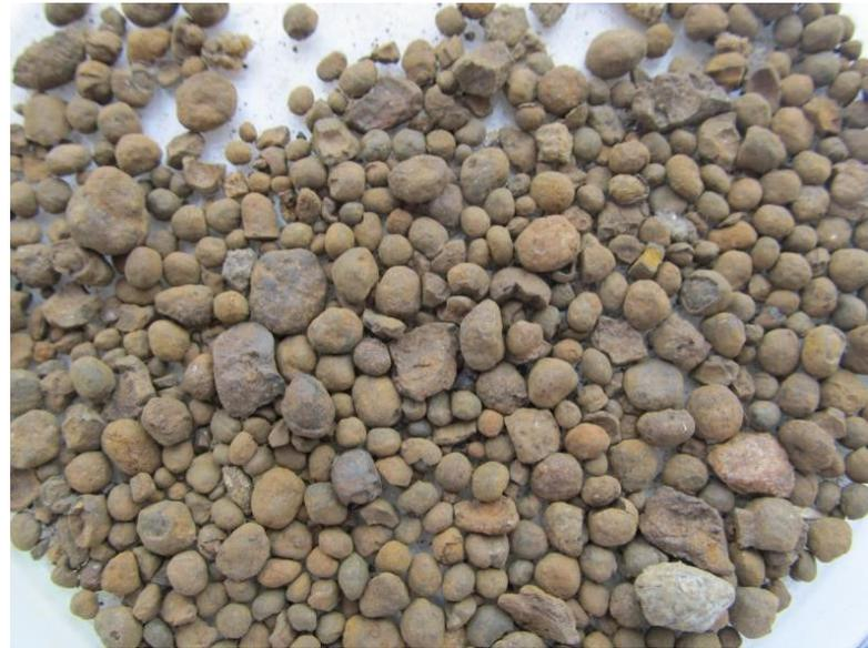
Монетные руды представлены скоплениями небольших (10,0-25,0 мм.) лепешкообразных оолитов. Они образуются за счет стягивания коллоидных масс вокруг небольших обломков горной породы и круговым «болтанием» в прибрежной полосе. Корковые руды – агрегаты оолитов, с цементированные гидроксидами железа и марганца. Губчатые руды – пористые массы разных размеров.
