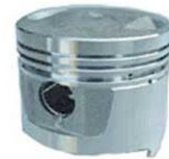
Рис. Механічно оброблена заготовка поршня
