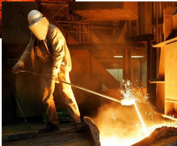
Рис. Метал на хім аналіз
