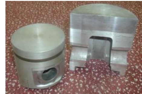
Рис. Лита заготовка поршня
