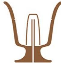
Чаша Пифагора выглядит как обычная кружка для питья. За исключением того, что в центре чаши расположен купол, в основании которого есть два отверстия. Высота купола находится на уровне критической отметки чаши. Внутри купола проходит трубка, которая ведет к основанию чаши и далее к отверстию на самом дне.
