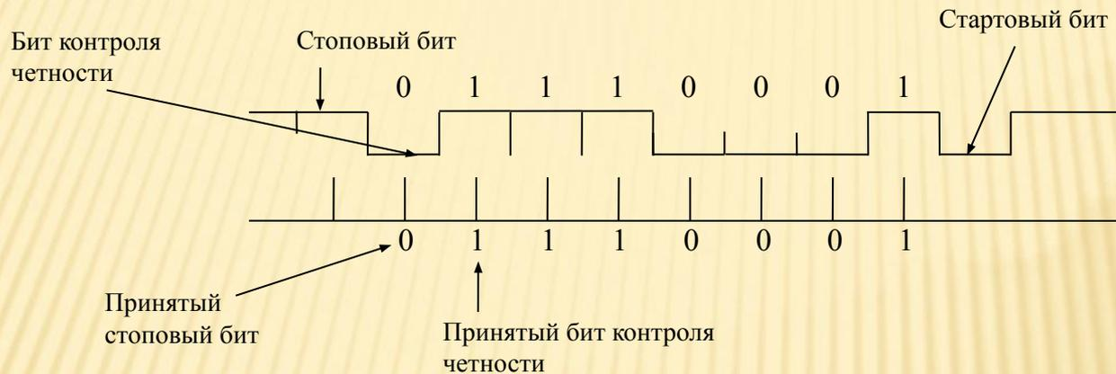
передача и прием данных при согласованной тактовой частоте
