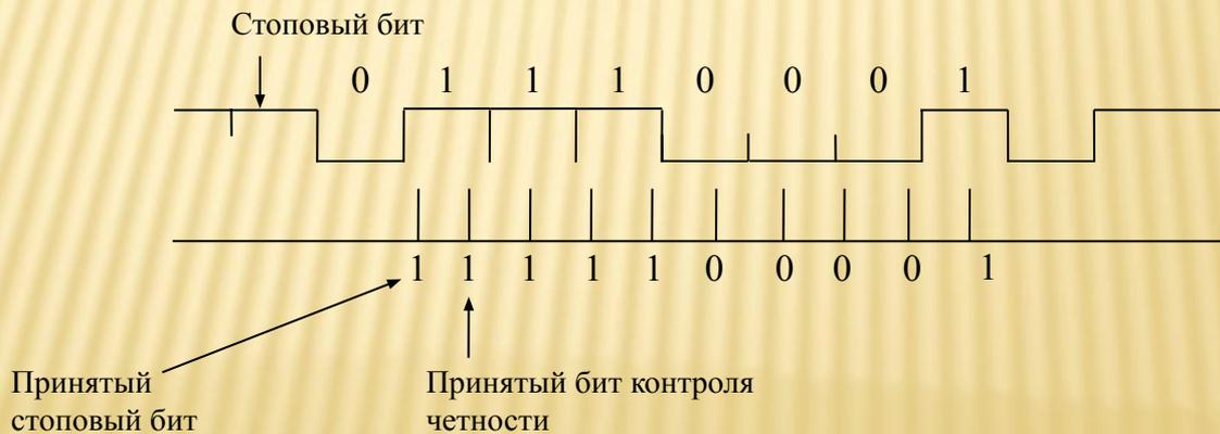
передача и прием данных при несогласованной тактовой частоте
