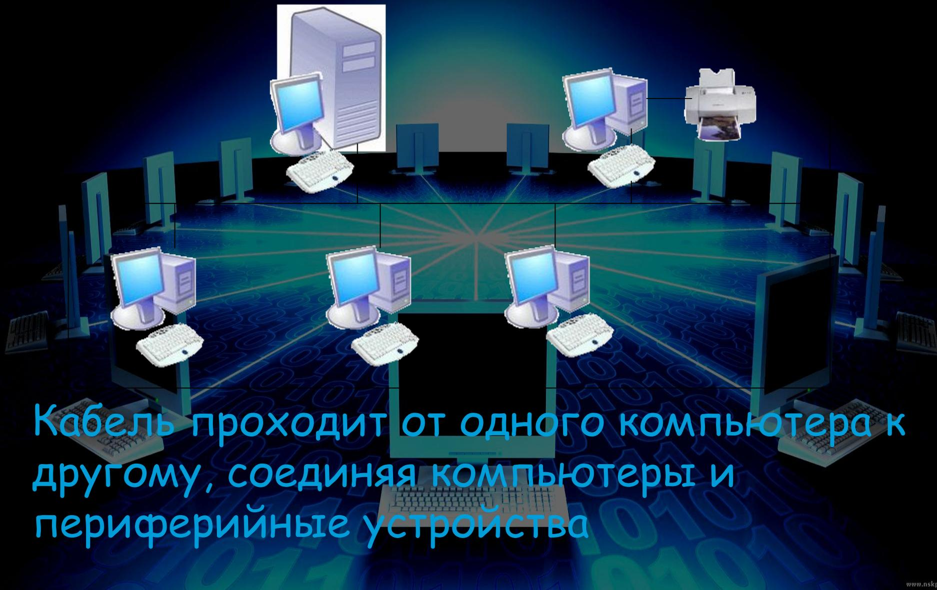
Кабель проходит от одного компьютера к другому, соединяя компьютеры и периферийные устройства
