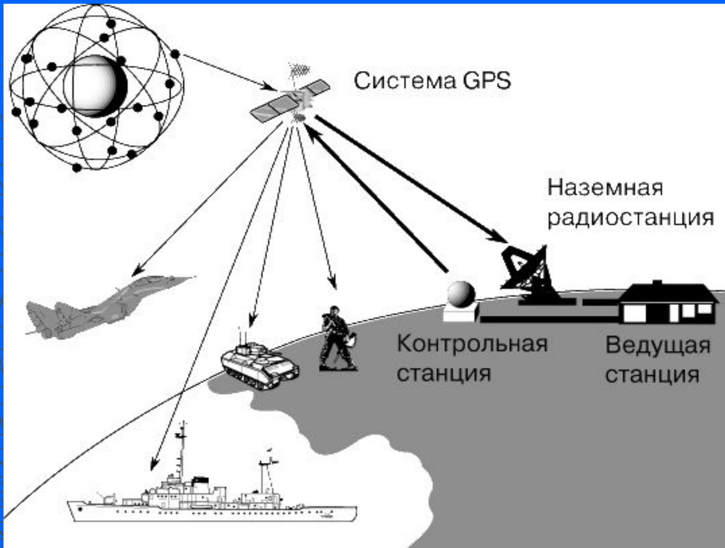
**ГЛОБАЛЬНАЯ СИСТЕМА МЕСТООПРЕДЕЛЕНИЯ GPS, спутниковая навигационная система, в которую входят 24 спутника (21 рабочий и 3 резервных), передающих информацию о положении, скорости и времени военным и гражданским пользователям**
