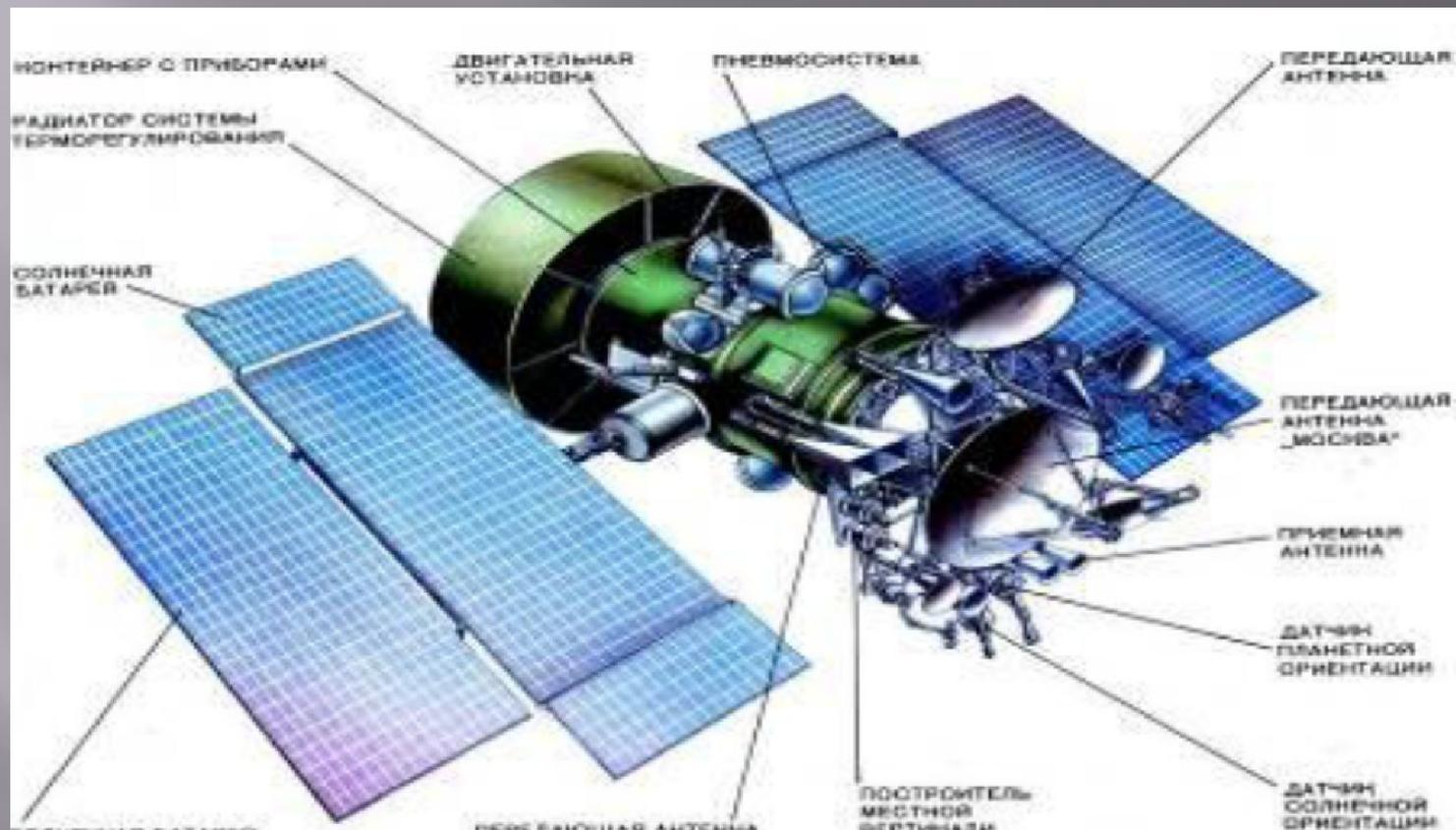
Рис. 1.7 – Космический аппарат связи «Горизонт»
