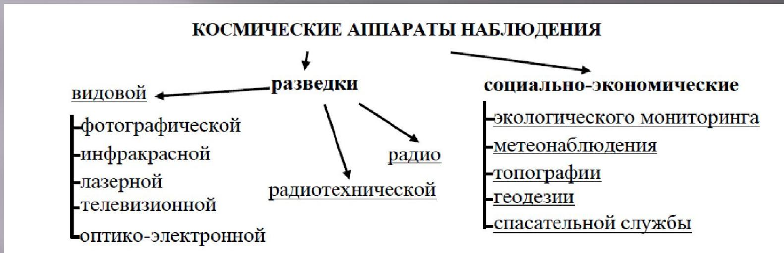
Рис. 1.14 – Классификация космических аппаратов наблюдения
