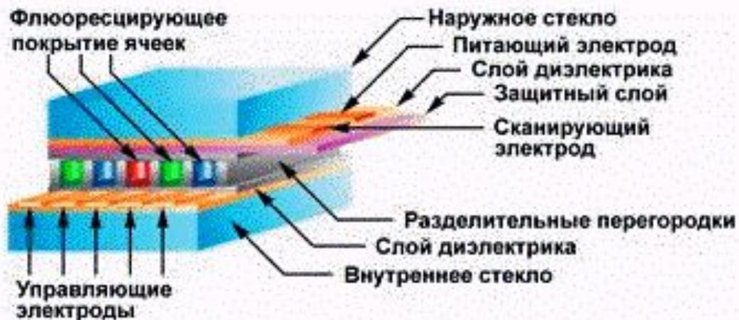
Плазменная панель представляет собой матрицу газонаполненных ячеек, заключенных между двумя параллельными стеклянными пластинами, внутри которых расположены прозрачные электроды, образующие шины сканирования, подсветки и адресации. Разряд в газе протекает между разрядными электродами (сканирования и подсветки) на лицевой стороне экрана и электродом адресации на задней стороне.
