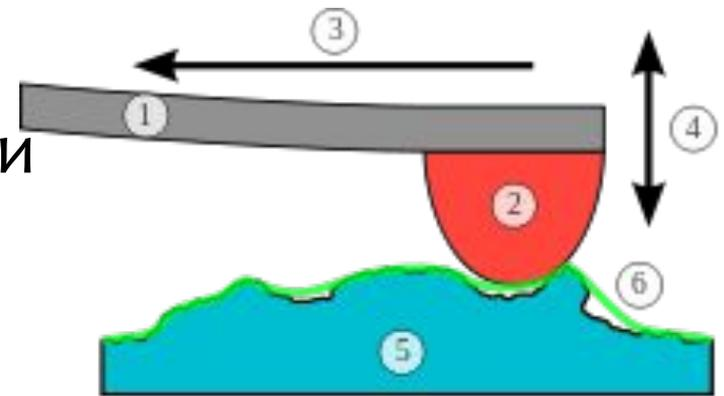
В технике профилометры в основном предназначены для измерений в лабораторных и цеховых условиях машиностроительных, приборостроительных и других предприятий, а также в полевых условиях, шероховатости поверхностей изделий, сечение которых в плоскости измерения представляет прямую линию.
