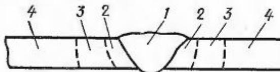
Рисунок 1 – Стыковое сварное соединение
