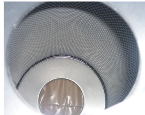
**Рекомендуется** устанавливать в составе фильтрогруппы совместно с сепараторами топливными СТ-500 (до и после сепараторов) после насосных агрегатов или в напорные линии ПН. Могут иметь тонкость фильтрования 20 мкм и 5 мкм.
