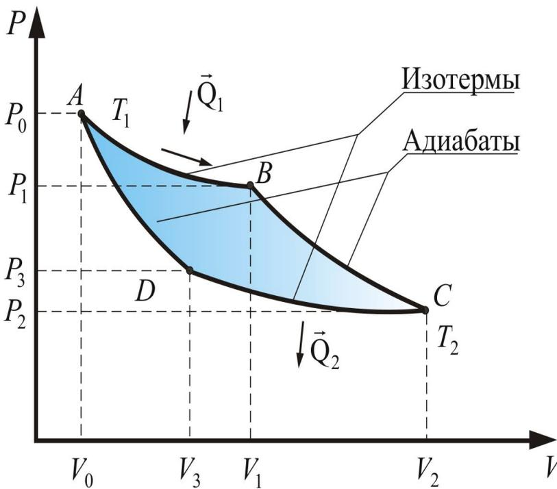
*В точке D изотермическое сжатие заканчивается. Теперь нужно вернуть газ в исходное состояние (точку A). Для этого его **изолируют от холодильника и адиабатически сжимают (DA), при этом температура его повышается от  $T_2$  до  $T_1$**  за счет того, что работа, внешних сил, совершенная над газом, переходит в его внутреннюю энергию и увеличивает ее.*
