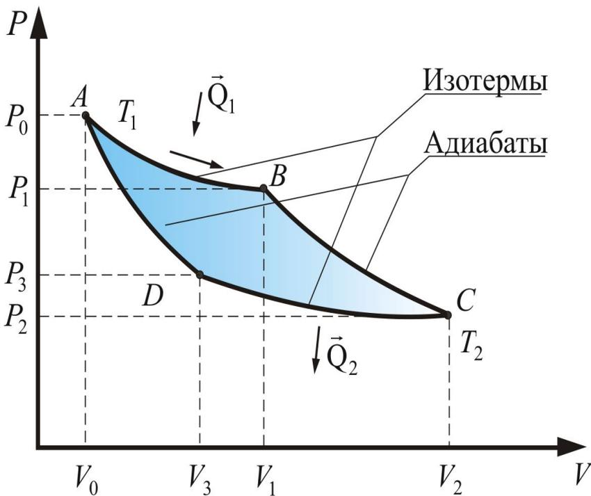
*На участке  $AB$  происходит изотермическое расширение при температуре  $T_1$ , газ совершает работу за счет теплоты  $Q_1$  получаемой от нагревателя при температуре  $T_1$ . Здесь не происходит необратимой передачи тепла от более нагретого тела к менее нагретому, передаваемое тепло сразу переходит в работу. Данный процесс обратим.*
