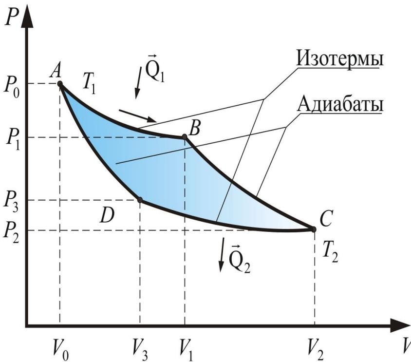
Для этого в точке  $B$  газ отключают от контакта с нагревателем и совершают процесс адиабатического расширения  $BC$ , в ходе которого газ продолжает совершать работу, но теперь уже за счет своей внутренней энергии, убыль которой и снижает его температуру до  $T_2$
