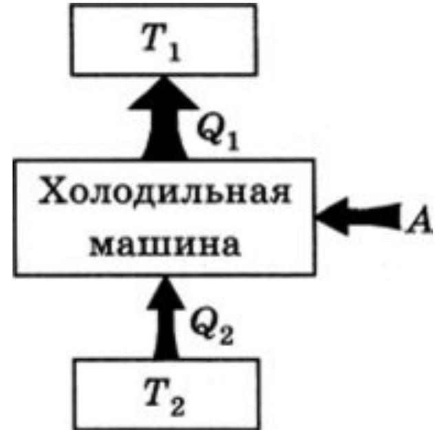
*Холодильная машина отбирает за цикл от холодного резервуара с температурой  $T_2$  количество теплоты  $Q_2$ , добавляет к ней работу  $A$ , превращенную в тепло, и отдает резервуару с более высокой температурой  $T_1$  большее количество теплоты  $Q_1$ .*
