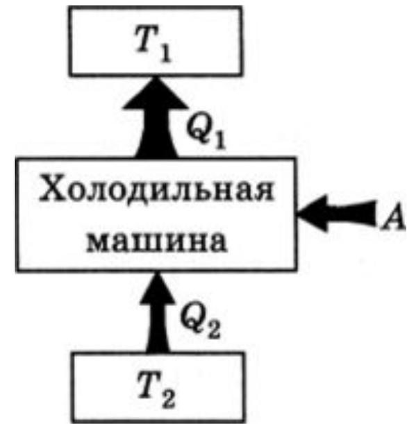
*Эффективность холодильной машины характеризуется ее холодильным коэффициентом, который определяется как отношение отнятой от охлаждаемого тела теплоты  $Q_2$  к работе  $A$ , которая затрачивается на приведение машины в действие.*
