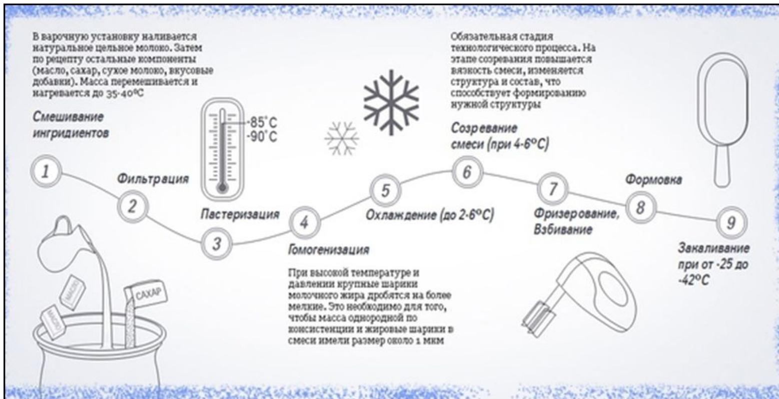
Технологическая схема производства мороженого
