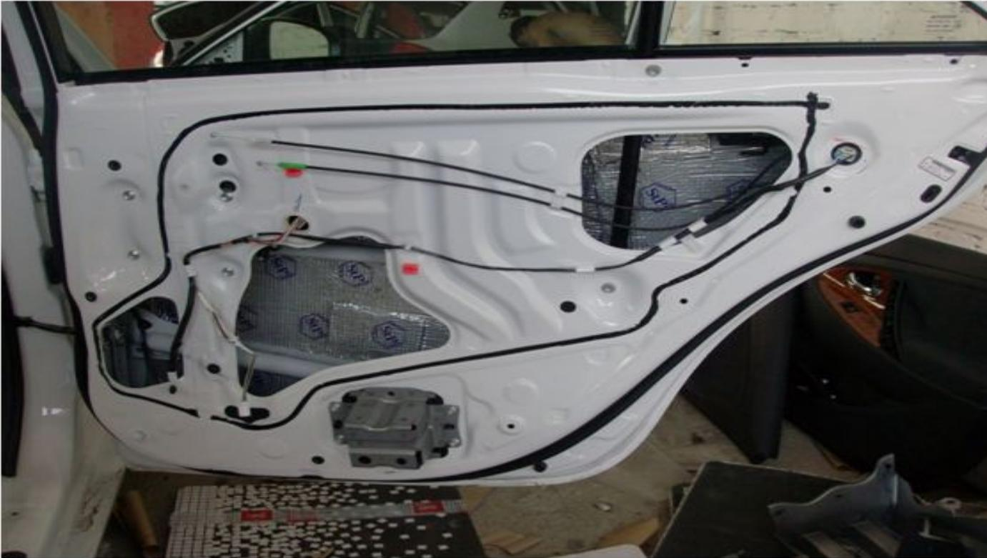
Оклеивание шумоизоляцией внутренней стороны
