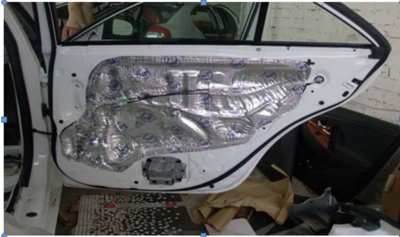
Оклеивание шумоизоляции вторым слоем
