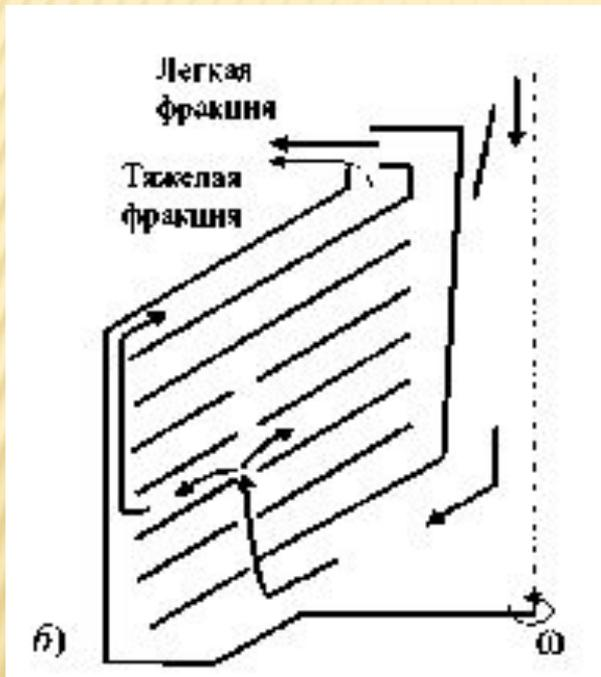
При работе сепараторов исходная жидкость подается в барабан, проходит по каналам между основанием и тарелкодержателем и по каналам, образованным отверстиями в тарелках, поступает в пакет тарелок. Под действием центробежной силы происходит разделение жидкости на легкую и тяжелую фракции. По специальным каналам, не смешиваясь, они выводятся из барабана.
