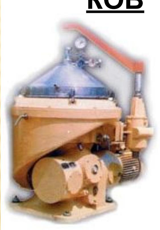
**Сепаратор Г9-КОВ** предназначен для очистки плодовоовощных соков. Он относится к сепараторам тарельчатого типа в полужакрытом исполнении с периодической выгрузкой осадка.
