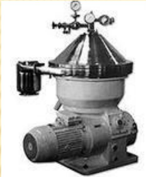
Предназначен для отделения твердых взвесей из жидкости.
