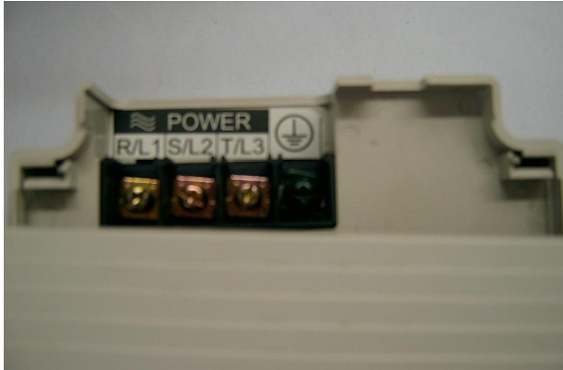
Электрическое подключение преобразователя. Напряжение между каждыми двумя линиями составляет 380В, а напряжение между каждой линией заземления составляет 220В. (Допускается отклонение +/- 10В.) (Электрическое подключение должно проводиться квалифицированными электротехниками.)
