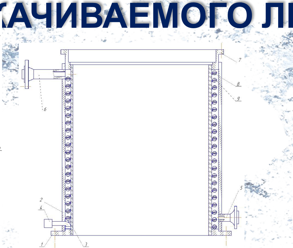
Испаритель: 1 – фланец; 2 – цилиндр наружный; 3 – цилиндр внутренний; 4 – трубка; 5 – штуцер подачи хладагента; 6 – штуцер отвода паров хладагента; 7 – рама опорная; 8 – поплавок; 9 – держатель терморезистора
