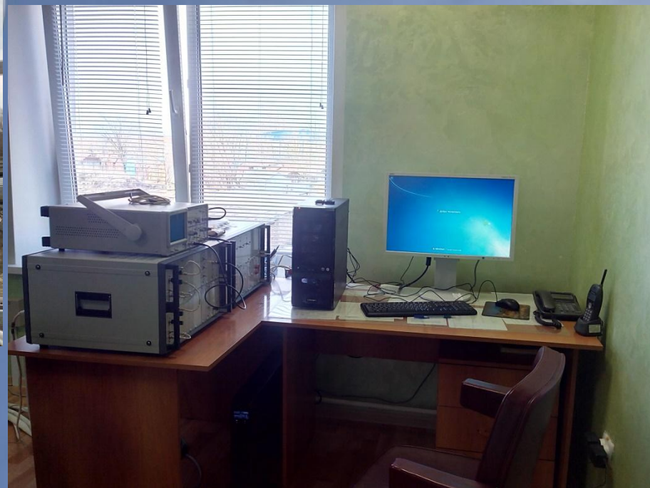
ПОСТ ОПЕРАТОРА КОМПЬЮТЕР, БЛОК ОБРАБОТКИ И УПРАВЛЕНИЯ, БЛОК ПИТАНИЯ, ОБЯЗАТЕЛЬНО ОСЦИЛЛОГРАФ
